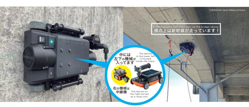
「SPIRADER」は、東日本旅客鉄道株式会社と株式会社オンガエンジニアリングが共同開発した最新鋭の非破壊検査ロボットです。KEYTEC の世界最新電磁波レーダ FlexNX の「NX25」を搭載し、コンクリート内部の鉄筋位置やかぶり厚さ、埋設管、空洞、ひび割れなどを正確に測定することが可能です。従来、人による点検が困難だった高所や危険個所へ安全かつ高精度なアクセスを可能とし、建物やインフラ設備の保守・点検業務の遠隔化・自動化を実現します。
